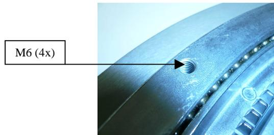
Nun wird der Drehkranz als Schablone verwendet und die 4 Positionen auf die Tischplatte aufgezeichnet. Danach werden Löcher mit  $\varnothing 7$  mm gebohrt und die passenden Schrauben M6 von unten in die Tischplatte eingesetzt.
