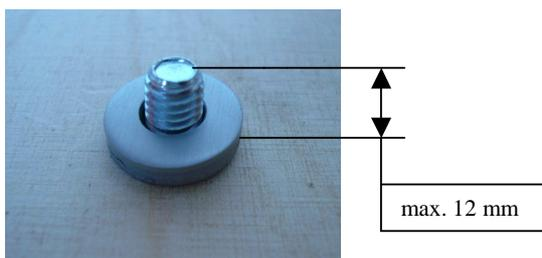
Jetzt wird der Drehteller von oben auf die Schrauben gesetzt. Diese werden festgedreht, so dass der Drehteller nach dem Anziehen der Schrauben plan auf der Tischplatte aufliegt.
