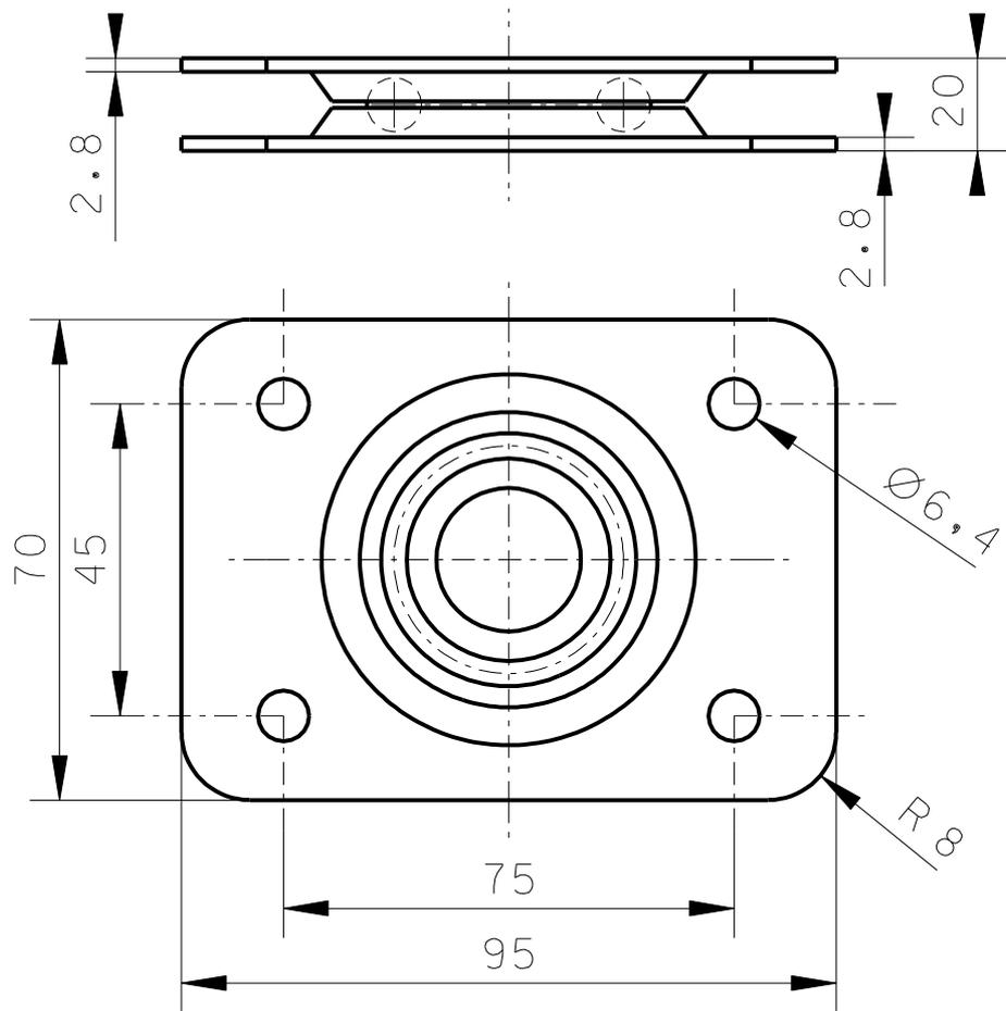
Oberfläche galvanisch verzinkt    Blechdicke: 2,8 mm    Axial belastbar bis 280 kg
