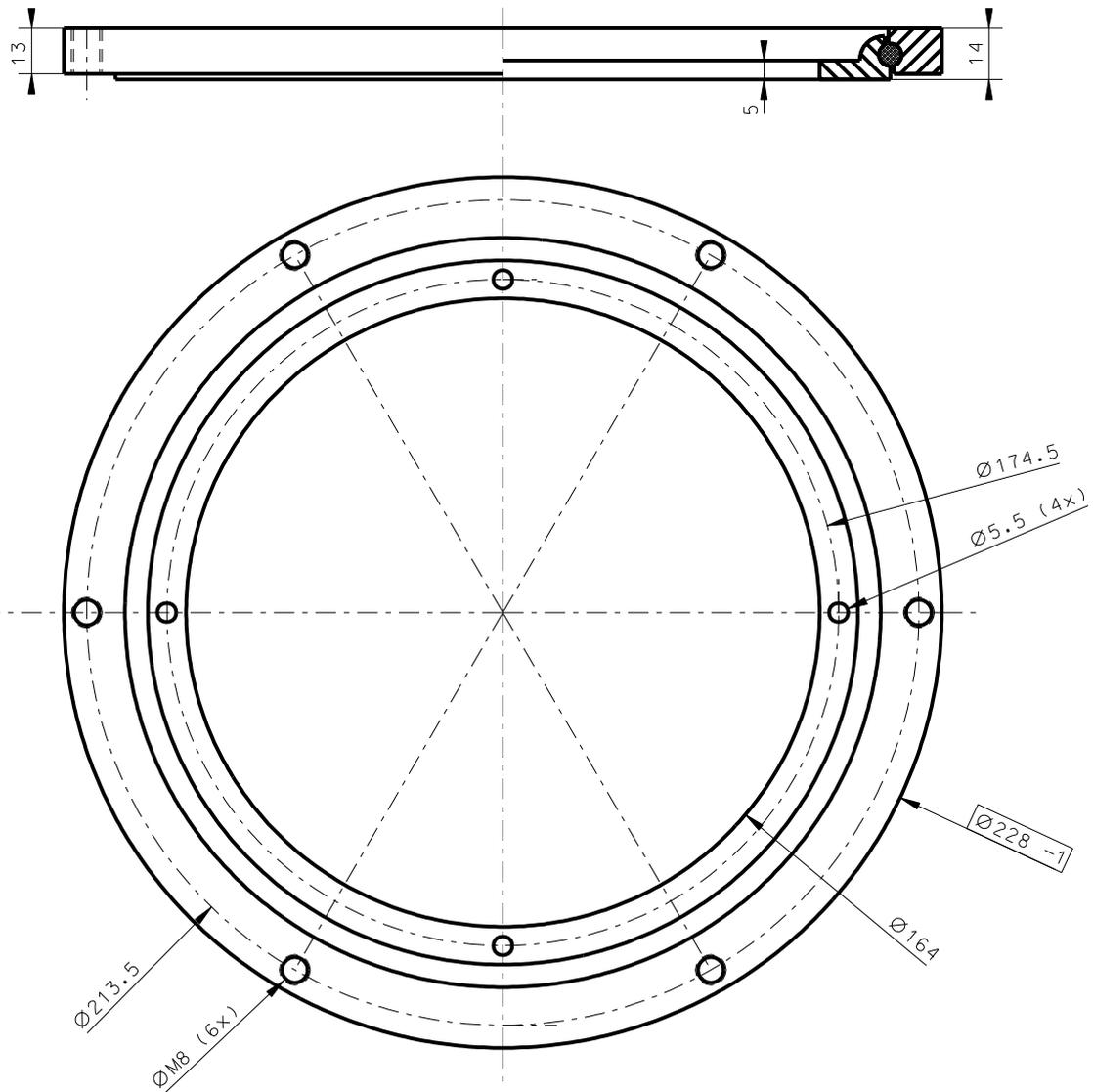
Innenring: 4 x Bohrung 5,5 mm
