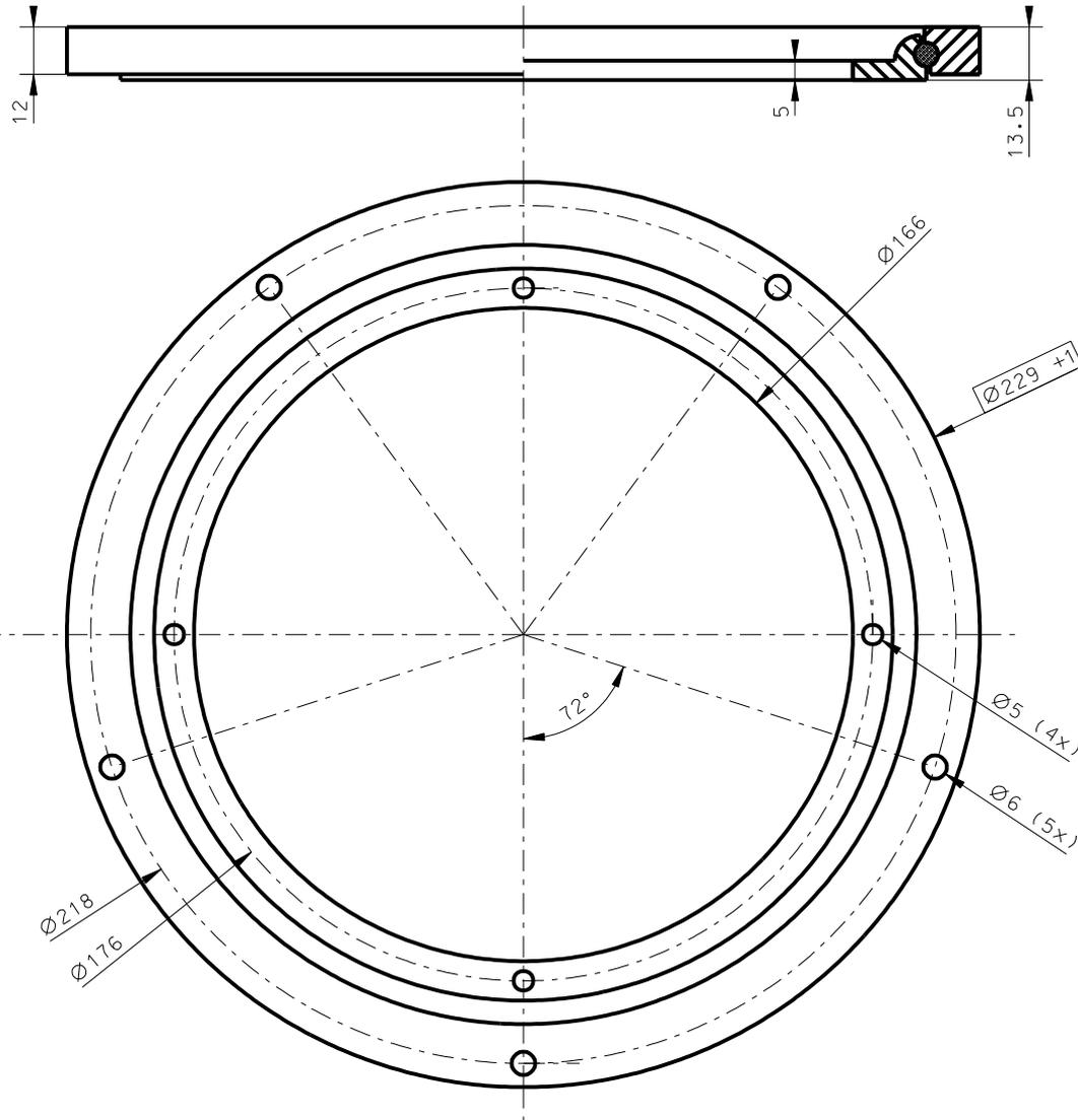
Innenring: 4 x Bohrung 5 mm
